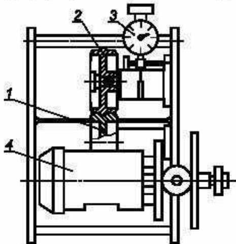
1, 2 — муфты для смятия гофров или рилевания; 3 — приспособление для регулирования зазора между муфтами;
